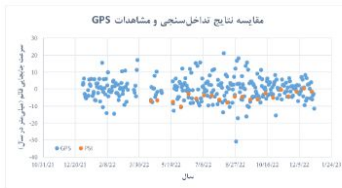
تصویر ۹. مقایسه نتایج مستخرج از تحلیل تداخل‌سنجی PSI و مشاهدات ایستگاه GPS در راستای قائم (تهیه شده توسط نگارنده)
